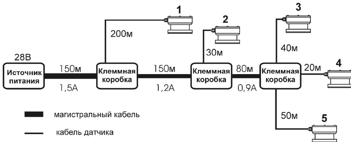
Примем сечение подводящего кабеля, соединяющего датчики и клеммные коробки равным  $0,5\text{мм}^2$ , напряжение источника питания 28 В. Определим минимально-достаточное сечение проводов питания магистрального кабеля.
