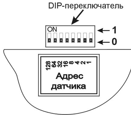
Рис.12.1. Переключатель Modbus адреса в положении все нули.
