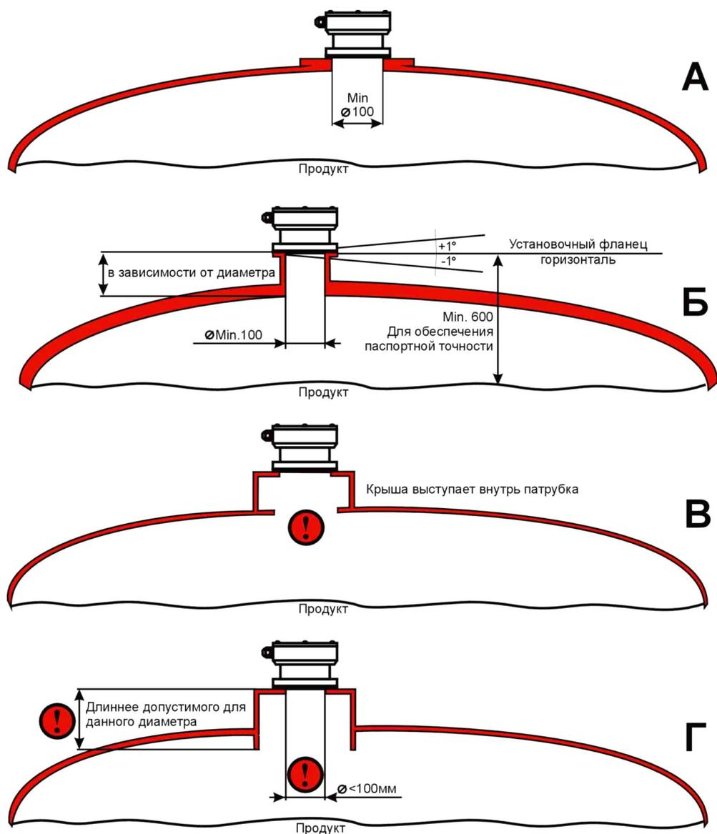
Рис.7.2. Примеры правильного (А, Б) и неправильного (В-Г) монтажа датчика уровня.
