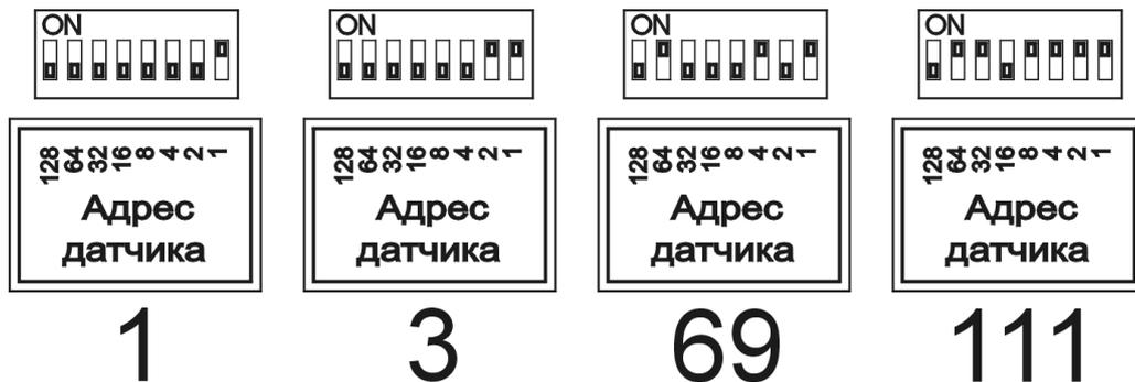
Рис.12.2. Примеры установки различных Modbus адресов.
